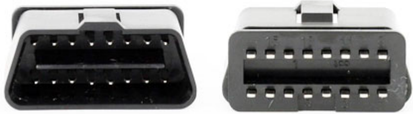
OBD-II Connector-adapter f. Globalsat GTR-129
